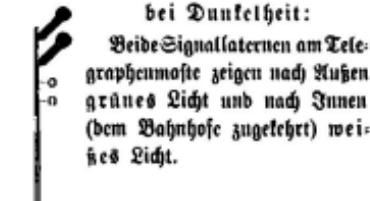
Beide Signallaternen am Telegraphenmaste zeigen nach Außen grünes Licht und nach Innen (dem Bahnhofe zugelteht) weißes Licht.
