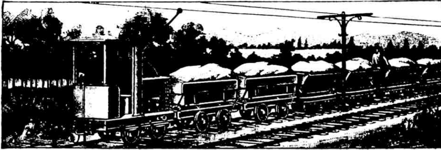
Feldbahn mit elektrischem Betrieb.
